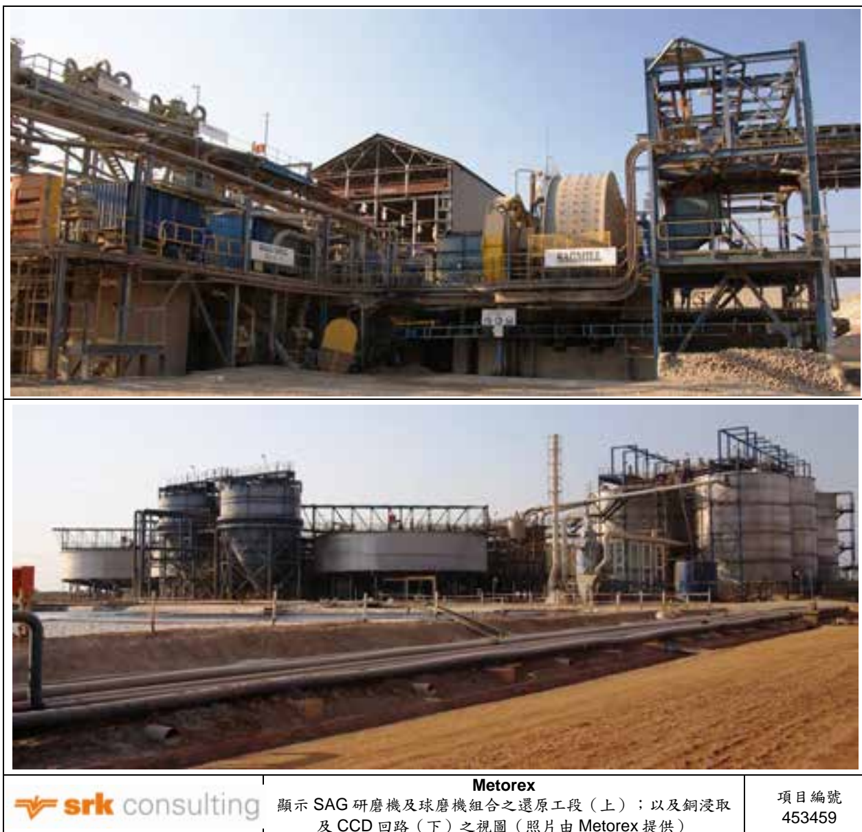
圖 3.26： 顯示 SAG 研磨機及球磨機組合之還原工段（上）；以及銅浸取及 CCD 回路（下）之視圖
