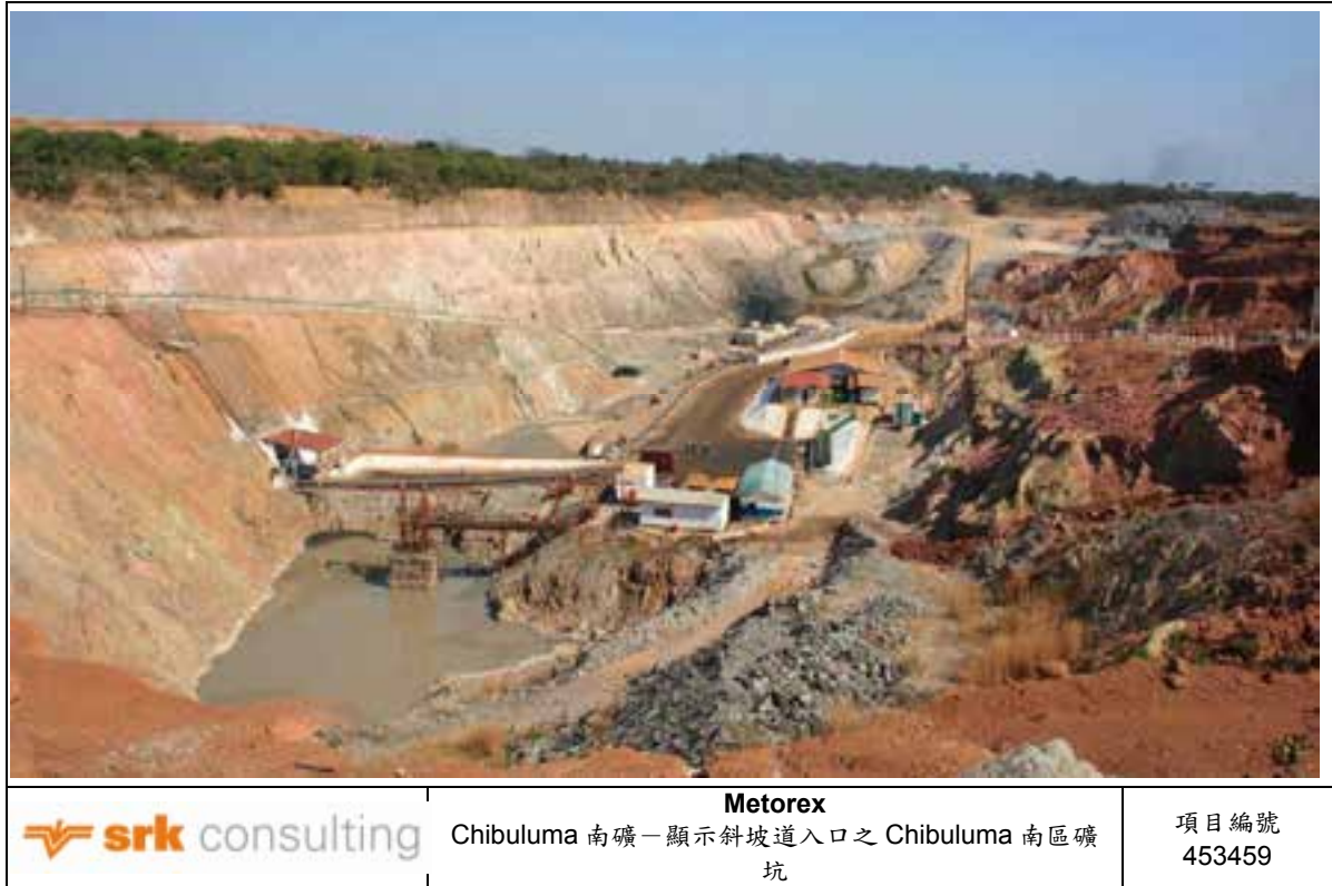
圖 4.15： Chibuluma 南礦－顯示斜坡道入口之 Chibuluma 南區礦坑
