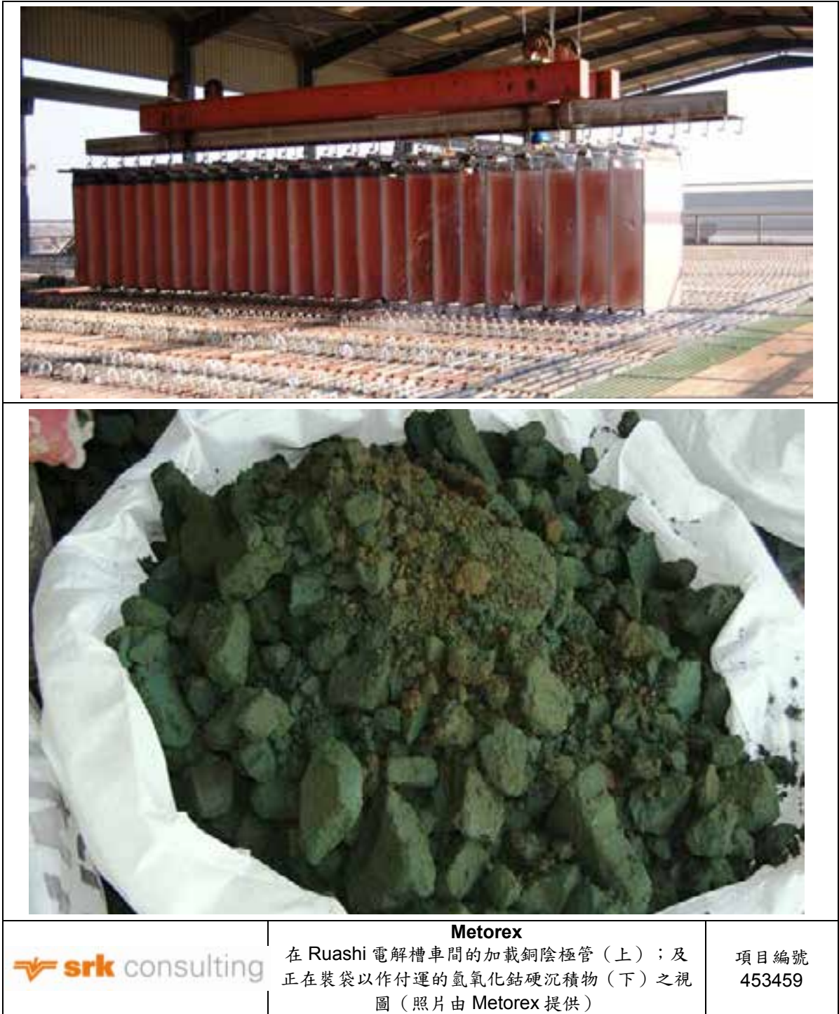
圖 3.27： 在 Ruashi 電解槽車間的加載銅陰極管（上）；及正在裝袋以作付運的氫氧化鈷硬沉積物（下）之視圖
