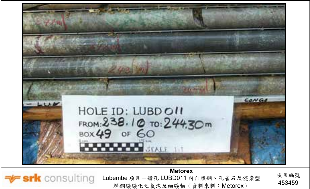
圖 7.5 : Lubembe 項目—鑽孔 LUBD011 內自然銅、孔雀石及侵染型輝銅礦礦化之氣泡及細礦物 (資料來料: Metorex)
